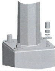
Montaż słupa do fundamentu / Pole mounting on the foundation
