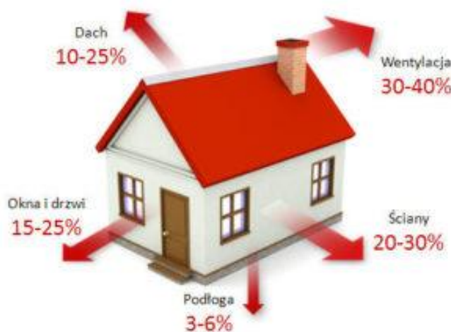
Rysunek 22. Procentowa strata ciepła w budynku 15
